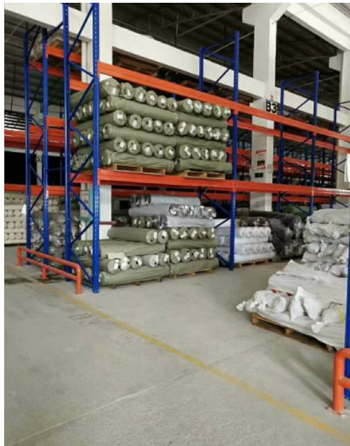
重型横梁式货架通常为重型货架，在国内的各种仓储货架系统中比较常见，由立柱、横梁、横撑、斜撑以及自锁螺栓组装而成，可以有效防止螺栓松动后引发货架失稳；横梁采用特制的冷轧P型闭口梁；该结构具有简单、可靠、重量轻、承载力强、造价低的特点；柱卡与立柱连接时配有特殊设计安全销，可以确保横梁在外力撞击下不会脱落；层板采用国际上做的条状层板，具有承载力强、耐磨损、更换简单、维修成本低廉的特点。用途：重型横梁式货架成本低、安全可靠、组装、拆卸简单方便的特点；适用于人工存取，每层标准有效承载800kg以上.适合于人工存取箱式货物，或者与零件盒、周转箱配套装载零散重型货物。鼎辉智能仓储科技以客户永远满意为标准的一贯方针。广东轻型仓储货架供应商
