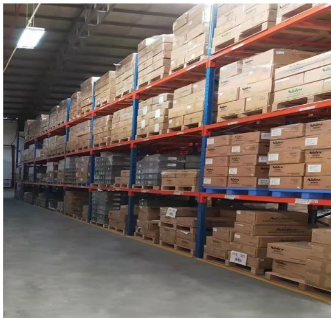
装配式货架采用组合式结构，调节灵活，拆装方便。组合货架要实现标准化、系列化，因为如果每个单位自行设计、制造组合货架，质量会缺乏保证，成本也会比较高。货架实现标准化设计和专业化生产，不仅能提高产品质量，使产品规格多样化、系列化，而且能节约原材料，降低成本。固定式货架主要是焊接或铆接的，不能拆卸，如货架不合乎要求或仓库位置有变化时，则只能将其丢弃不用，或者花大量费用进行改装。与之相比较，装配式货架则可以避免这些麻烦。装配式货架的特点是可以自由调节长、宽、高度，横隔层也可以上下组装。这种货架可以根据实际需要进行组装或拆卸，对储存空间进行灵活的调整，使其与存放物体的体积相适应。这样，可提高货架容积充满系数，增加其储存能力，并可满足物资品种、规格变化频率快、新品种层出不穷、变化莫测的市场的需要。广东轻型仓储货架供应商货架的立体结构，可充分利用仓库空间，提高仓库容量利用率，扩大仓库储存能力。
