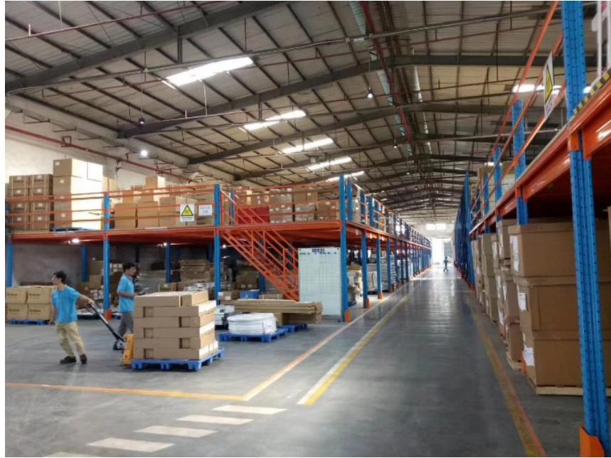
货架的生产工艺：生产工艺全自动冲床冲孔→辊轧线→电脑定尺剪折→二氧化碳保护焊→静电喷涂。货架的表面处理：货架的表面采用了环氧树脂静电喷涂处理，涂层厚60~80微米；除油→冲洗→酸洗除锈→冲洗→磷化→高压冲洗→烘干→静电喷涂→高温固化。货架的定期清洁：可以用干净的抹布把货架的灰尘擦除掉，切记清洁货架的时候尽量是要避开清水，因为用清水冲洗货架比较容易导致货架的表面发生氧化，会缩短货架的使用寿命，造成了不必要的浪费。
